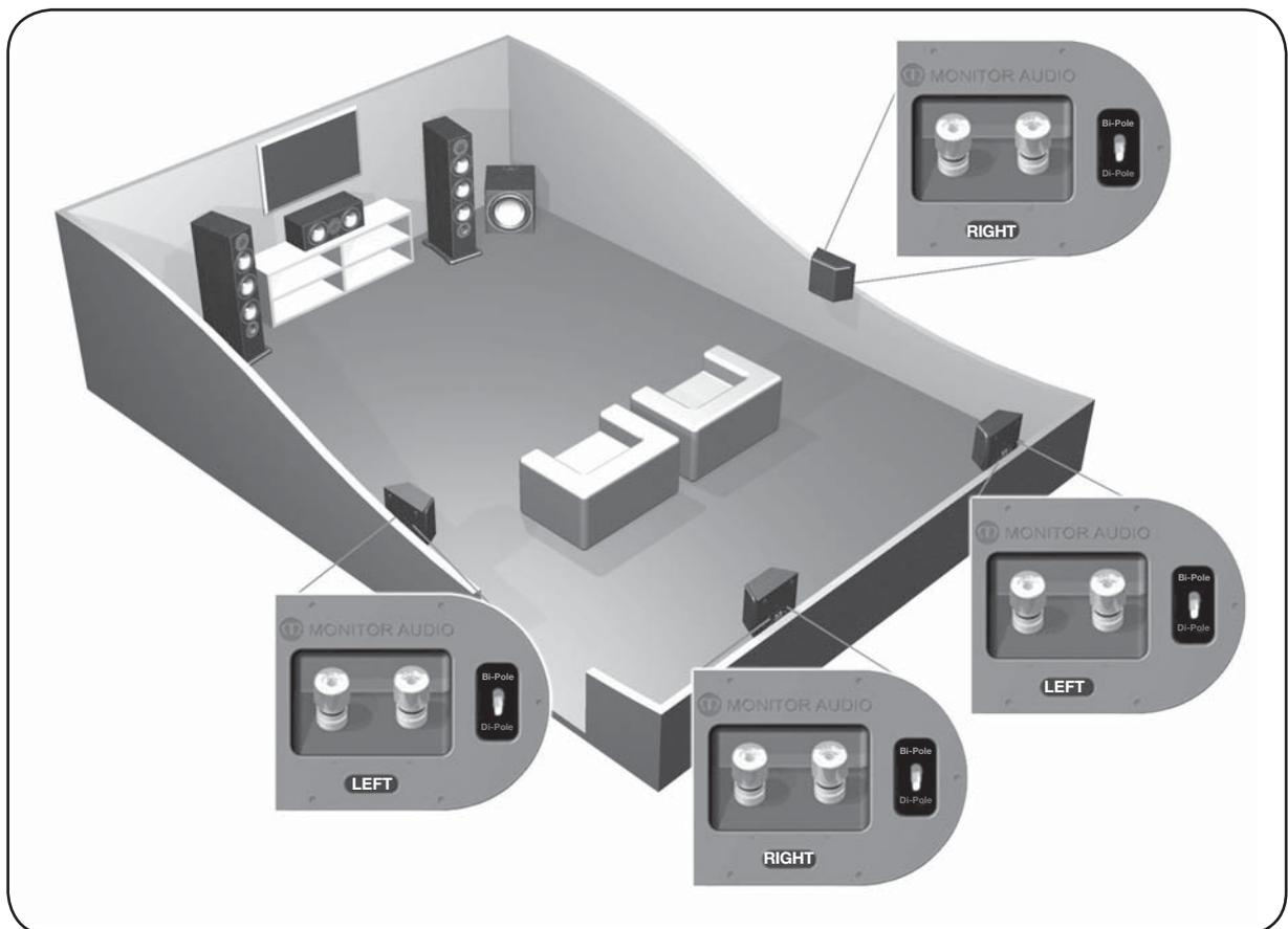
**ПРИМЕЧАНИЕ:** при использовании двух пар RX-FX в 7.1-канальной системе необходимо на левом тыловом канале пространственного звучания использовать правую АС (Right), а на правом тыловом канале пространственного звучания – левую АС (Left). Это связано с фазовой синхронизацией высокочастотных динамиков.
